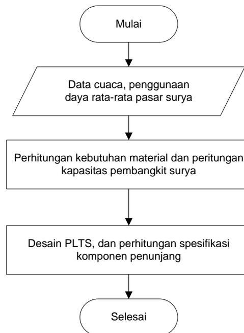
**Gambar 1.** Flowchart perencanaan Pembangkit Listrik Tenaga Surya
